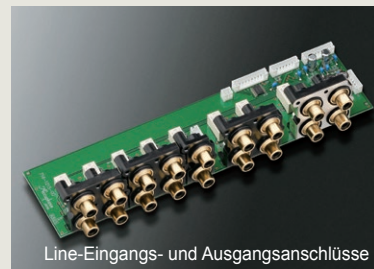
Line-Eingangs- und Ausgangsanschlüsse
