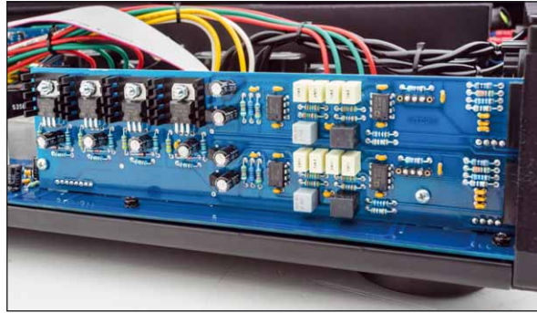
Klassische passive RIAA mit zwei beziehungsweise drei Verstärkerstufen im MC-Betrieb
