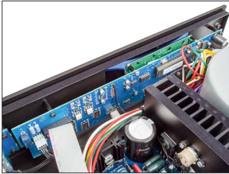
Vorne hinter der Frontblende sitzt die Steuerzentrale des Audia Flight
