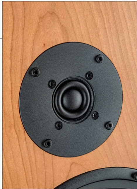
Der Hochtöner stammt von einem ausgewiesenen Spezialisten und ist mit seiner breiten Sicke hoch belastbar
